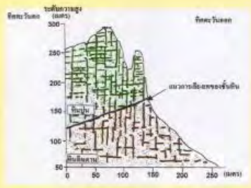
รูปที่ 1 ภาพตัดขวางแสดงการวางตัวของชั้นดินและลักษณะภูมิประเทศก่อนเกิดถล่ม
